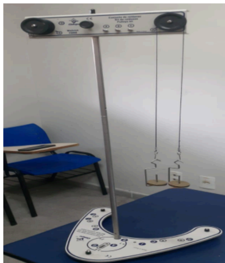
Figura 2 - Aparato Experimental da máquina de Atwood montado no LIDF.
